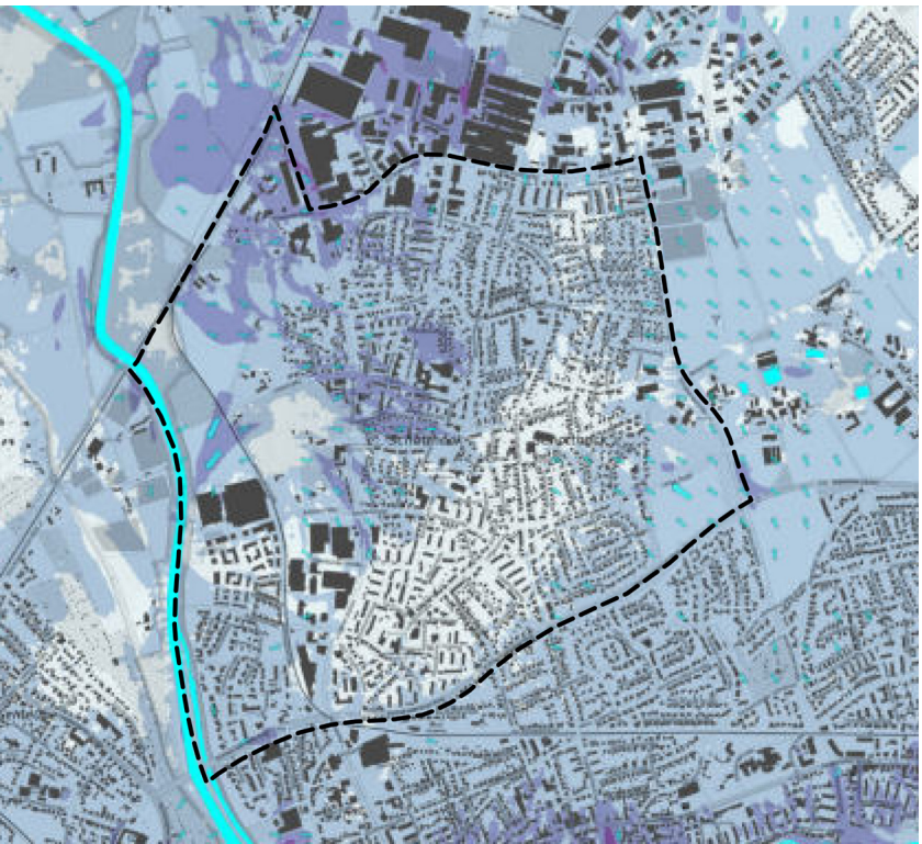
Abb.10: Stadtklimaanalyse Rheine: Kaltluftströmungsfeld in der Nacht Kaltluftvolumenstromdichte um 4 Uhr [ m 3 /m 2 /s ] ≤ 5,0 > 5,0 bis 10,0 > 10,0 bis 15,0 > 15,0 bis 20,0 > 20,0 ↑ Bodennahes Strömungsfeld um 4 Uhr aggregiert auf eine Auflösung von 100 m ● Gewässer ● Gebäude --- Gebietsgrenze
